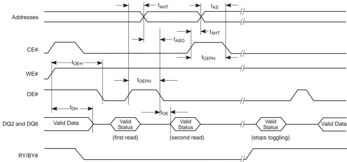
**Figure 31. DQ2 vs. DQ6 Relationship Diagram<sup>[166]</sup>**
