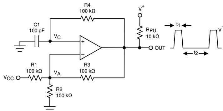
**Figure 8-9. Square-Wave Oscillator**
