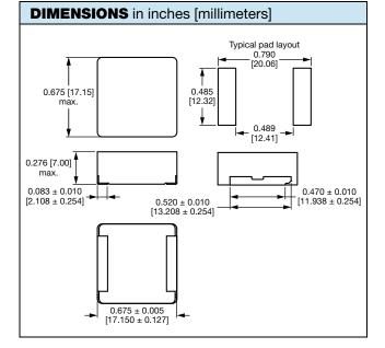
DESCRIPTION IHLP-6767GZ-5A ± 20 % 2.2 µH ER e3 JEDEC<sup>®</sup> LEAD (Pb)-FREE STANDARD MODEL INDUCTANCE VALUE INDUCTANCE TOLERANCE PACKAGE CODE **GLOBAL PART NUMBER** Т н Ρ 6 7 6 7 G Ζ Е R 2 R 2 Μ 5 Α L PRODUCT FAMILY PACKAGE INDUCTANCE TOL. SIZE SERIES CODF VALUE
