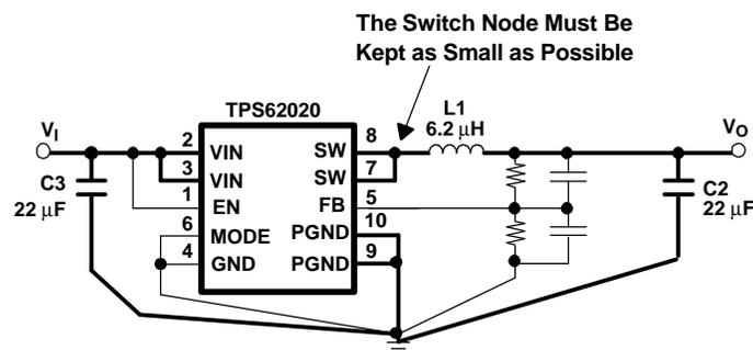
**Figure 16. Layout Diagram**
