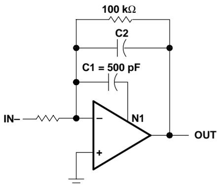
**Figure 3. Feed-Forward Compensation**
