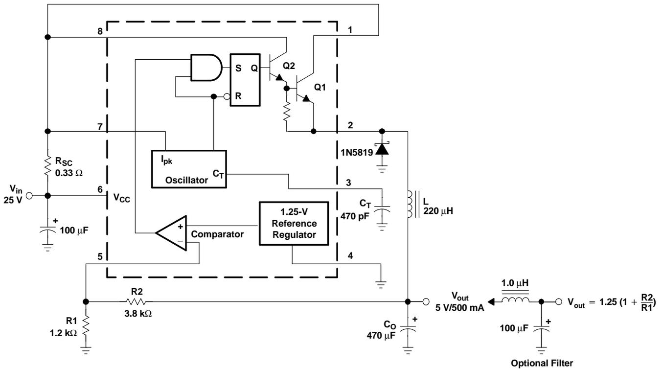
Figure 8. Step-Down Converter
