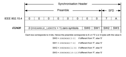
Figure 18. Transmitted Synchronisation Header
