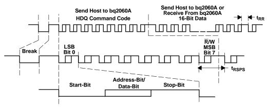
Figure 10. HDQ16 Communication Example
