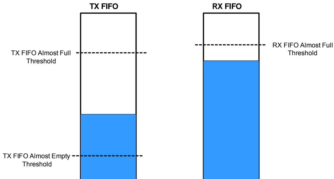
Figure 23.11. FIFO Thresholds
