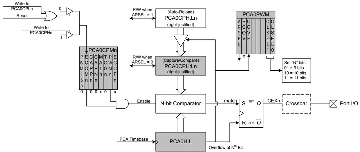
Figure 28.9. PCA 9, 10 and 11-Bit PWM Mode Diagram
