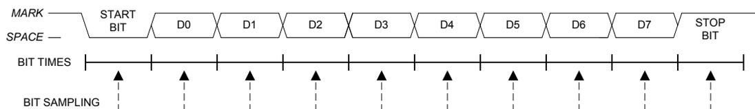
**Figure 25.4. 8-Bit UART Timing Diagram**
