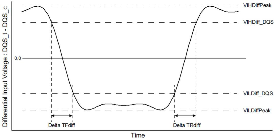
Figure 14. Differential Input Slew Rate Definition for DQS<sub>t</sub>, DQS<sub>c</sub>
