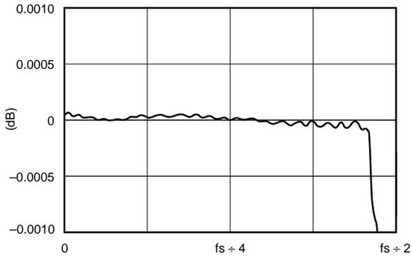
TOTAL PASS-BAND FREQUENCY RESPONSE, COMBINATION OF PCM1760 AND DF1760
