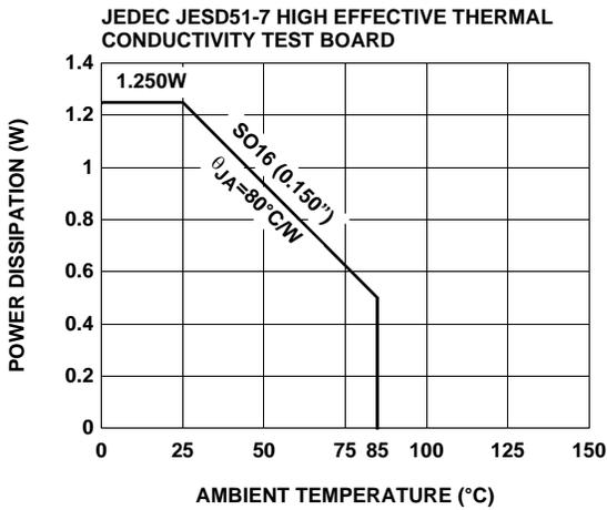
FIGURE 19. PACKAGE POWER DISSIPATION vs AMBIENT TEMPERATURE
