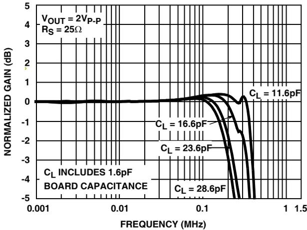
FIGURE 3. LARGE SIGNAL GAIN vs FREQUENCY vs  $C_L$
