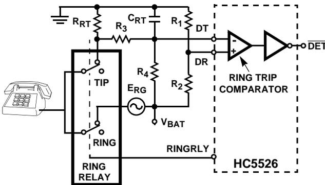
FIGURE 19. RING TRIP CIRCUIT FOR BATTERY BACKED RINGING
