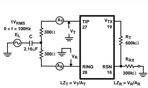
FIGURE 2. LONGITUDINAL IMPEDANCE
