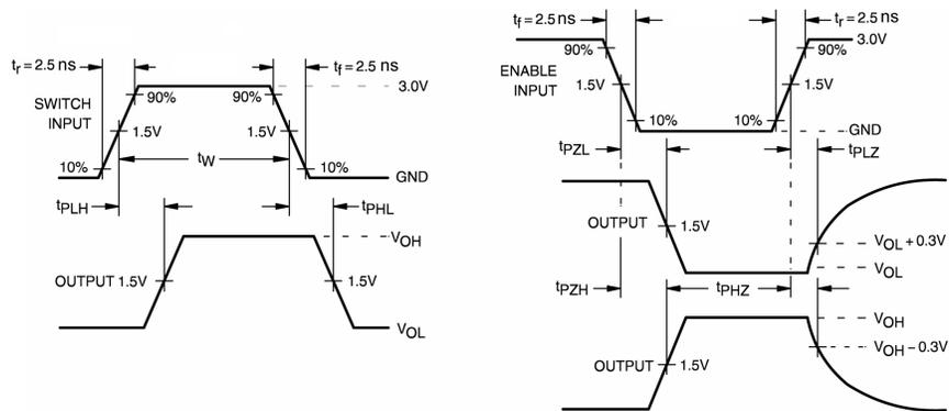
**FIGURE 3. AC Waveforms**
