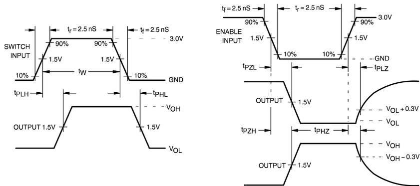
**FIGURE 3. AC Waveforms**
