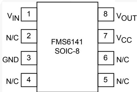
Figure 2. FMS6141 SOIC-8
