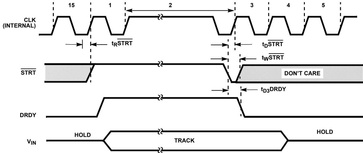
FIGURE 3. SINGLE SHOT MODE INTERNAL CLOCK
