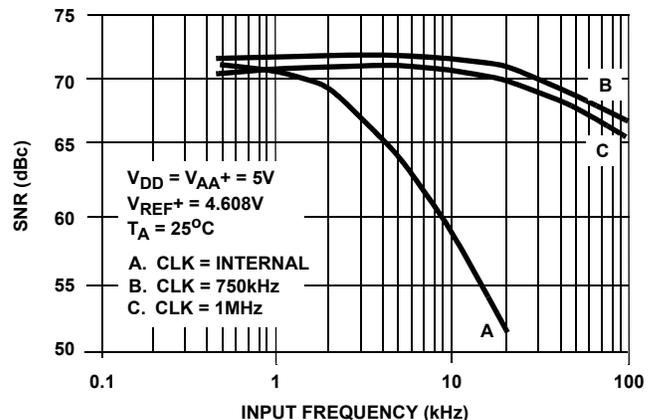
FIGURE 17. SIGNAL NOISE RATIO vs INPUT FREQUENCY
