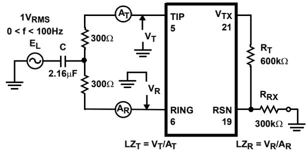
FIGURE 2. LONGITUDINAL IMPEDANCE
