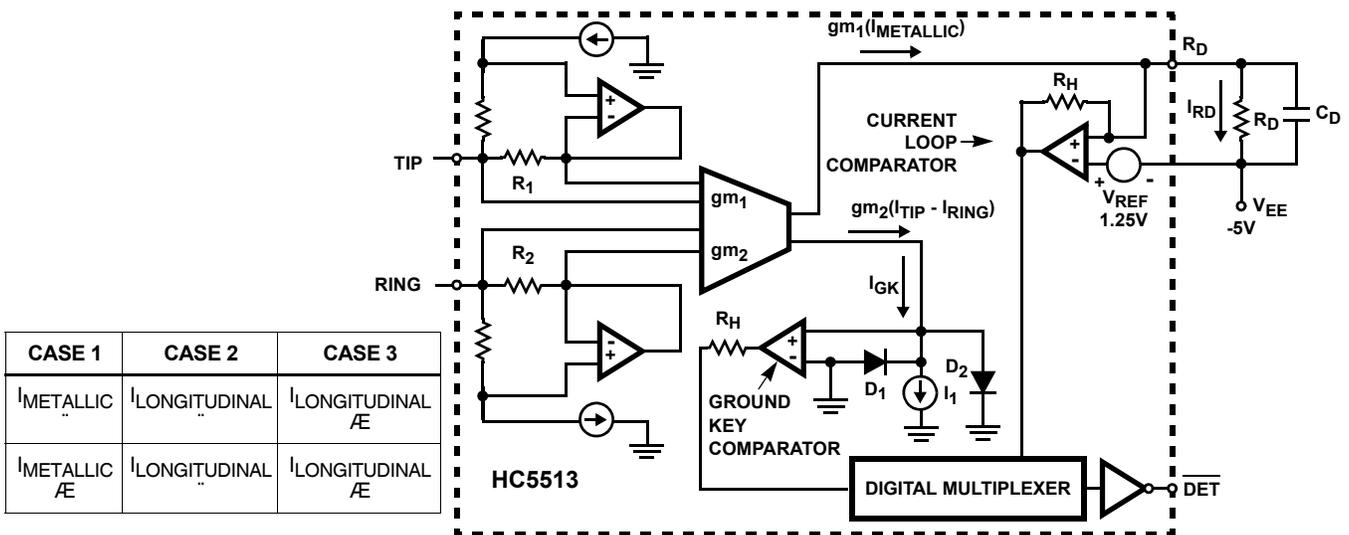
FIGURE 18. LOOP CURRENT AND GROUND KEY DETECTORS
