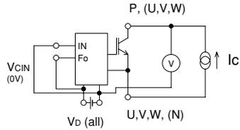
Fig. 1  $V_{CE(sat)}$  Test
