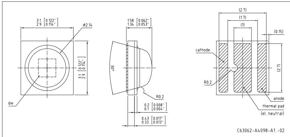
Anm.: Die LED enthält ein ESD-Bauteil, das parallel zum Chip geschalten ist.
