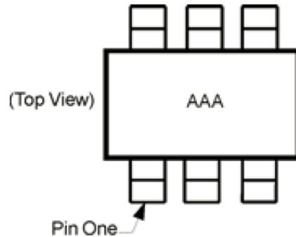
Figure 3. Pin One Orientation Diagram<sup>(1, 2)</sup>
