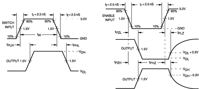
**FIGURE 2. AC Waveforms**
