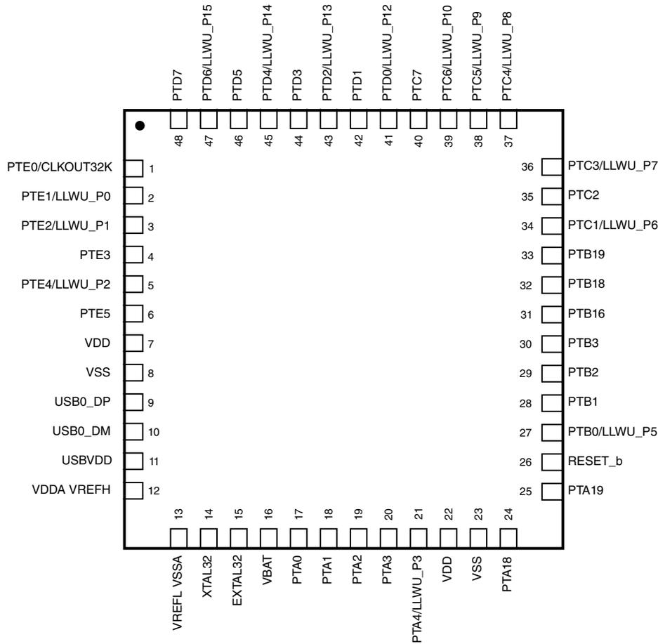
**Figure 8. 48 QFN Pinout Diagram**
