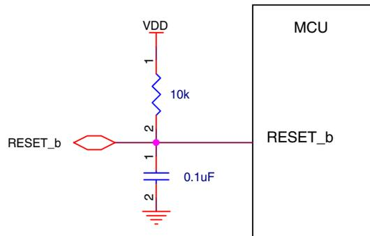
**Figure 43. Reset circuit**
