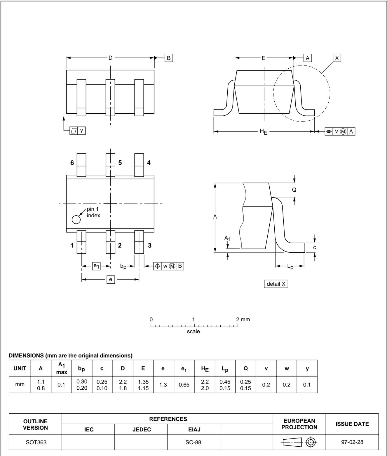
NPN resistor-equipped transistor; PNP
