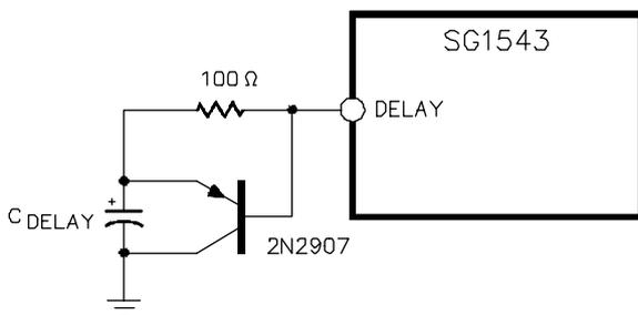
FIGURE 7 - SURGE LIMIT CIRCUIT FOR LARGE DELAY CAPACITORS
