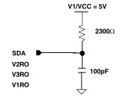
FIGURE 25. EQUIVALENT AC CIRCUIT
