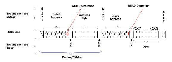
FIGURE 19. CONSTAT REGISTER READ COMMAND SEQUENCE
