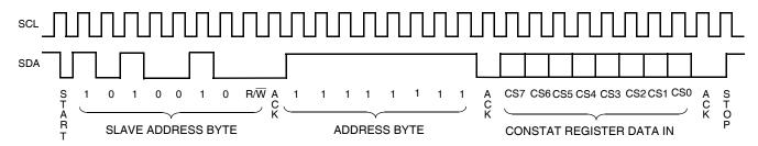
FIGURE 18. CONSTAT REGISTER WRITE COMMAND SEQUENCE
