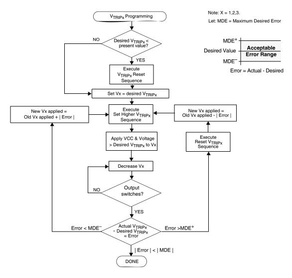
FIGURE 24. V<sub>TRIPx</sub> SETTING/RESET SEQUENCE (X = 1,2,3)
