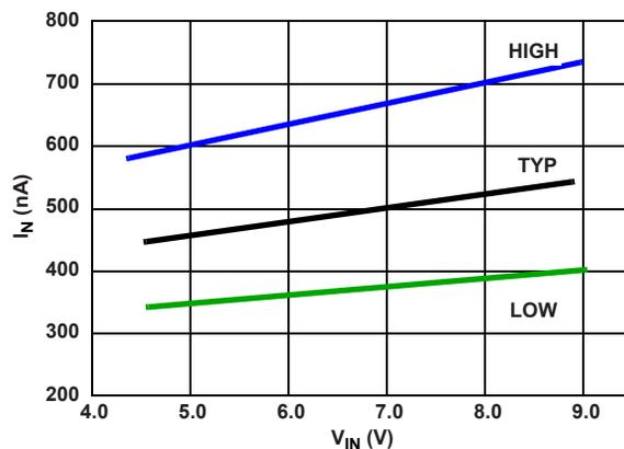
FIGURE 1. I<sub>IN</sub> vs V<sub>IN</sub> (3 UNITS)
