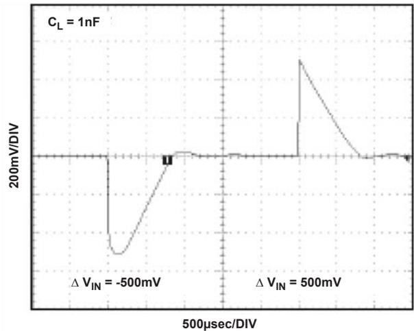
FIGURE 9. LINE TRANSIENT RESPONSE, 0.001µF LOAD CAPACITANCE
