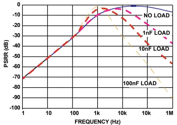
FIGURE 22. PSSR vs CAP LOAD
