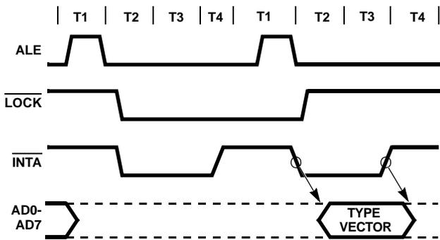
FIGURE 8. INTERRUPT ACKNOWLEDGE SEQUENCE
