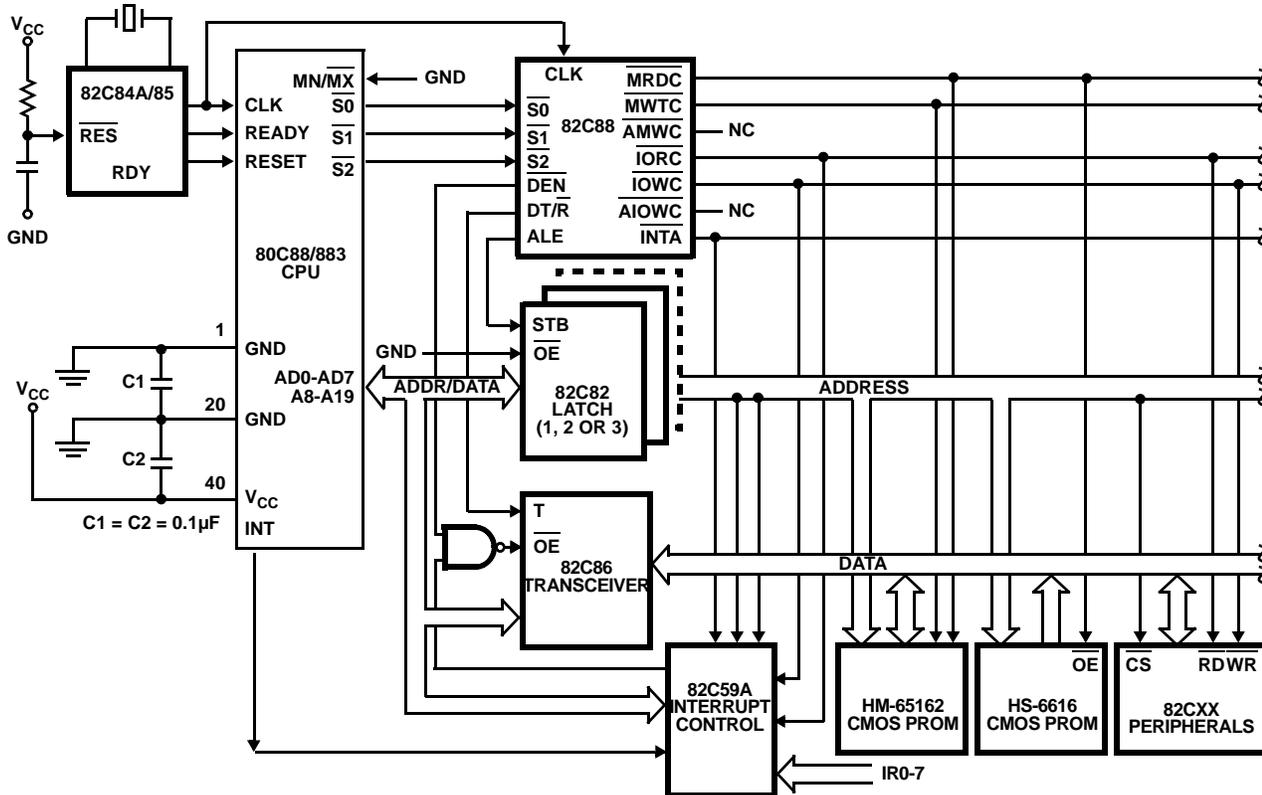
FIGURE 4. FULLY BUFFERED SYSTEM USING BUS CONTROLLER
