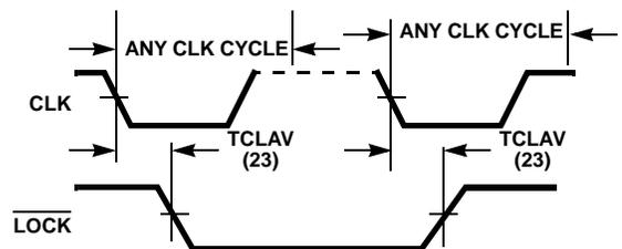
FIGURE 17. BUS LOCK SIGNAL TIMING (MAXIMUM MODE ONLY)
