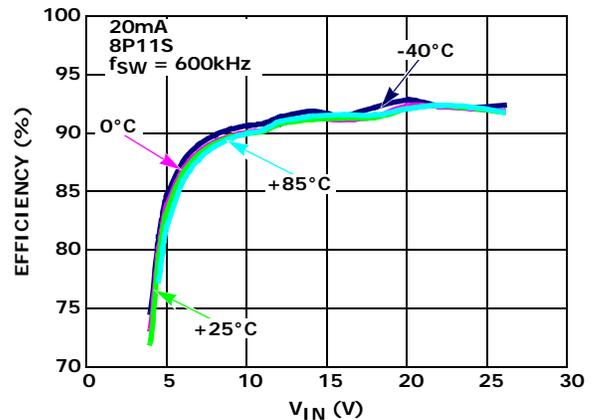
FIGURE 4. EFFICIENCY vs  $V_{IN}$  vs TEMPERATURE AT 20mA
