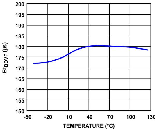
FIGURE 18. BATTERY OVP BLANKING TIME
