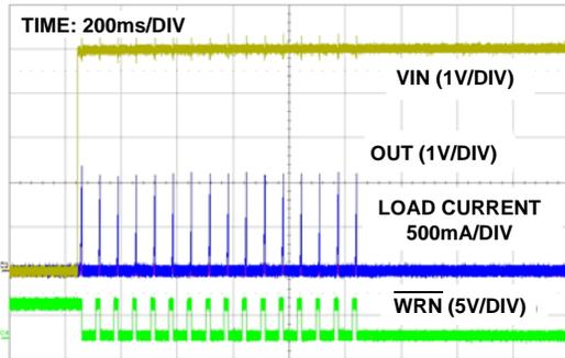
FIGURE 8. POWER-UP WAVEFORMS WHEN OUTPUT IS SHORT-CIRCUITED
