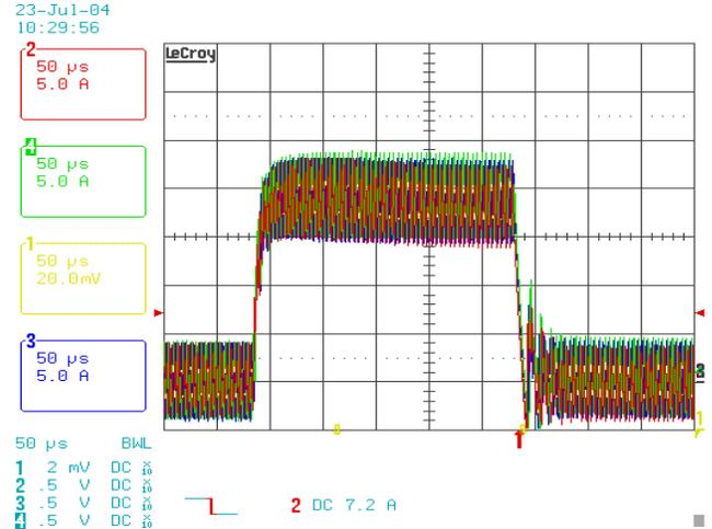
FIGURE 20. TRANSIENT LOAD 3 PHASE OPERATION - CURRENT BALANCE
