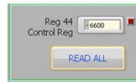
FIGURE 12. READ BACK FROM THE CONTROL REGISTER 44
