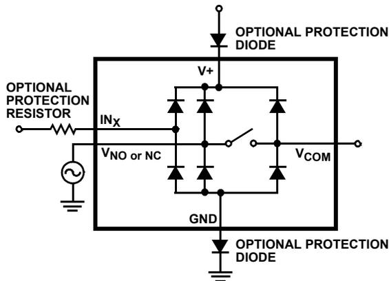
FIGURE 8. OVERVOLTAGE PROTECTION
