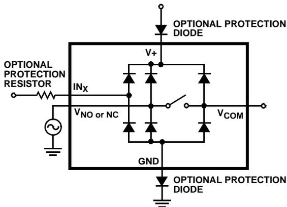
FIGURE 8. OVERVOLTAGE PROTECTION
