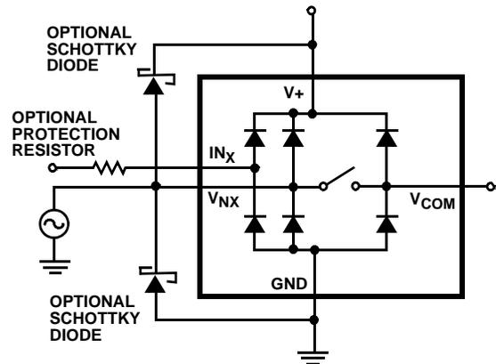
FIGURE 9. OVERVOLTAGE PROTECTION
