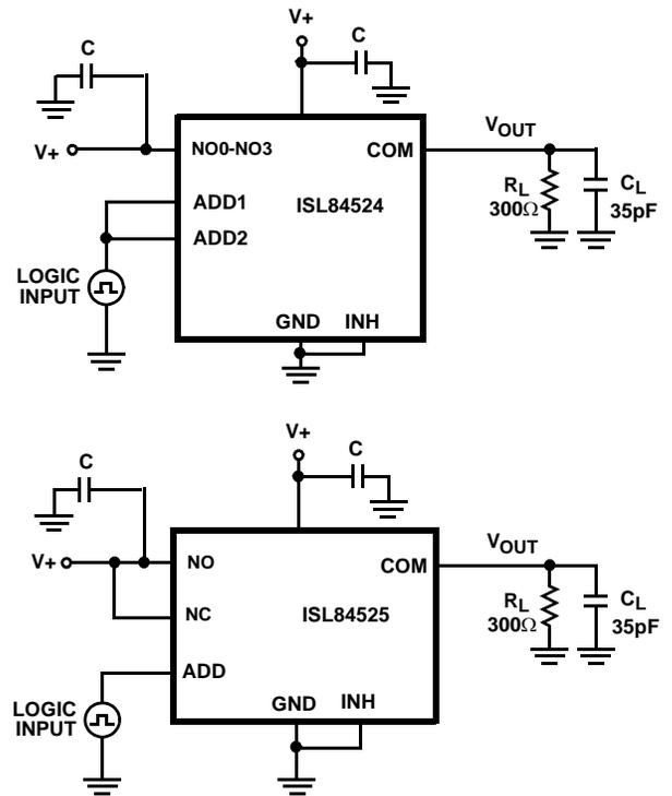
FIGURE 3B. TEST CIRCUIT
