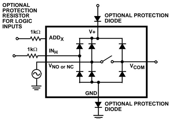
FIGURE 8. OVERVOLTAGE PROTECTION
