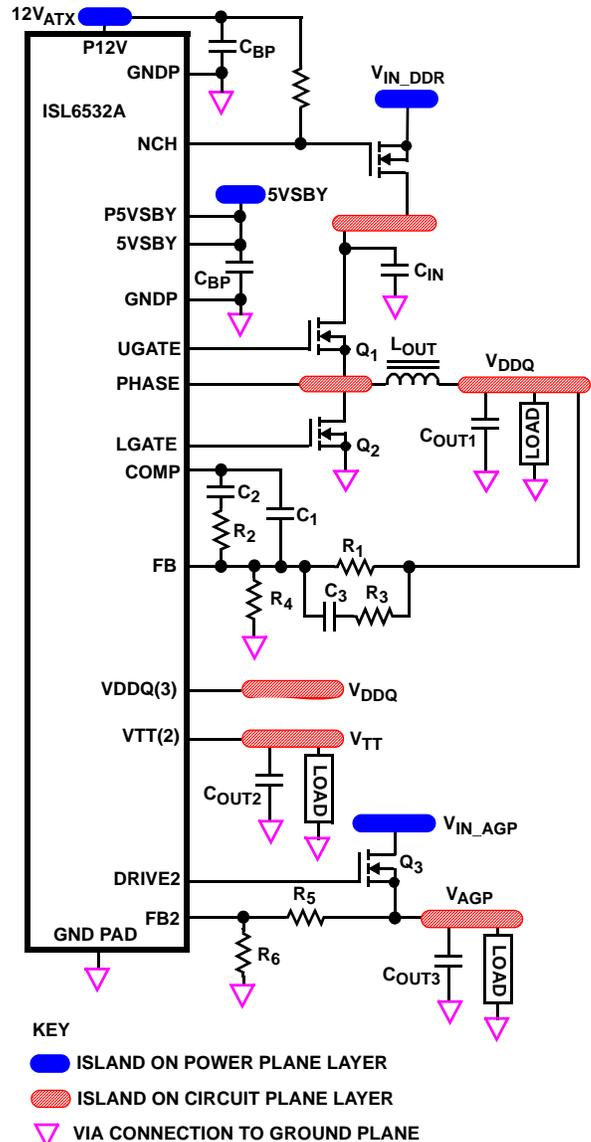
**FIGURE 4. PRINTED CIRCUIT BOARD POWER PLANES AND ISLANDS**
