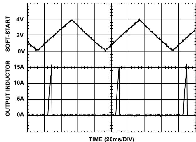
FIGURE 4. OVERCURRENT OPERATION
