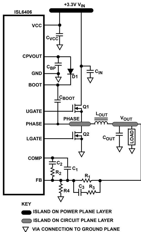
FIGURE 6. PRINTED CIRCUIT BOARD POWER PLANES AND ISLANDS
