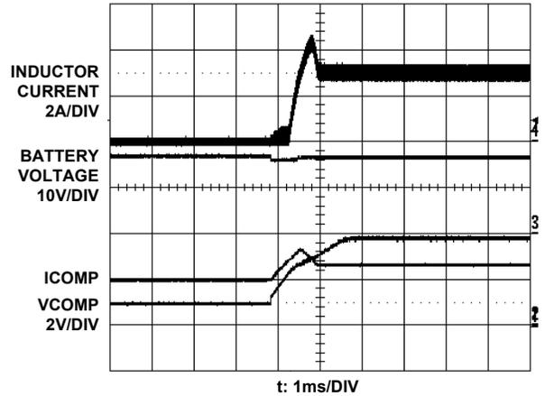
FIGURE 10. BATTERY INSERTION
