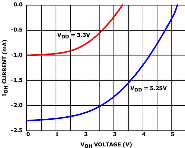
FIGURE 17.  $I_{OH}$  vs  $V_{OH}$  vs  $V_{DD}$  for  $\overline{\text{INT}}$
