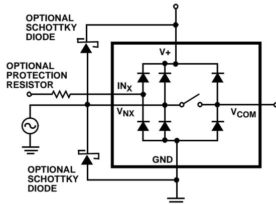
FIGURE 6. OVERVOLTAGE PROTECTION
