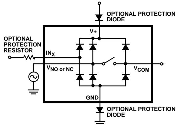
FIGURE 8. OVERVOLTAGE PROTECTION
