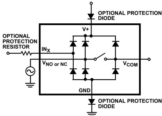
FIGURE 8. OVERVOLTAGE PROTECTION
