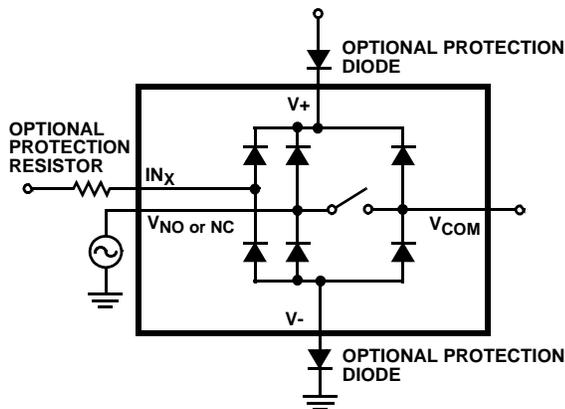
FIGURE 8. OVERVOLTAGE PROTECTION
