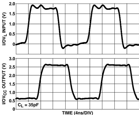
FIGURE 19. I/OV<sub>CC</sub> OUTPUT WAVEFORMS (100Mbps)
