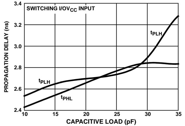
FIGURE 18. PROPAGATION DELAY vs I/OV<sub>L</sub> CAPACITIVE LOAD
