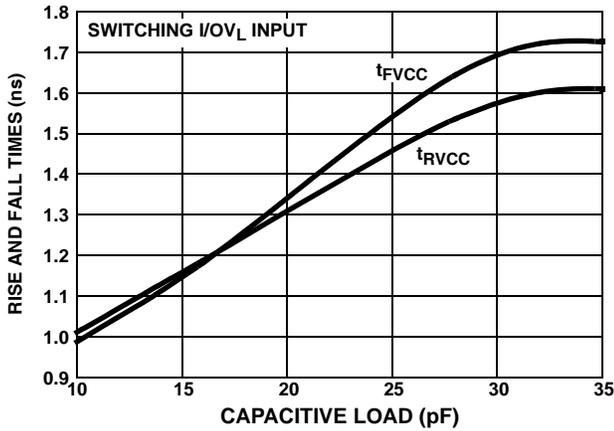
FIGURE 15. RISE/FALL TIME vs I/OV<sub>CC</sub> CAPACITIVE LOAD
