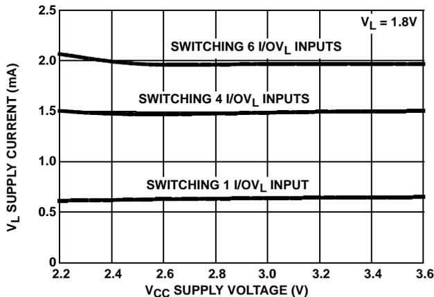
FIGURE 7. V<sub>L</sub> SUPPLY CURRENT vs V<sub>CC</sub> SUPPLY VOLTAGE
