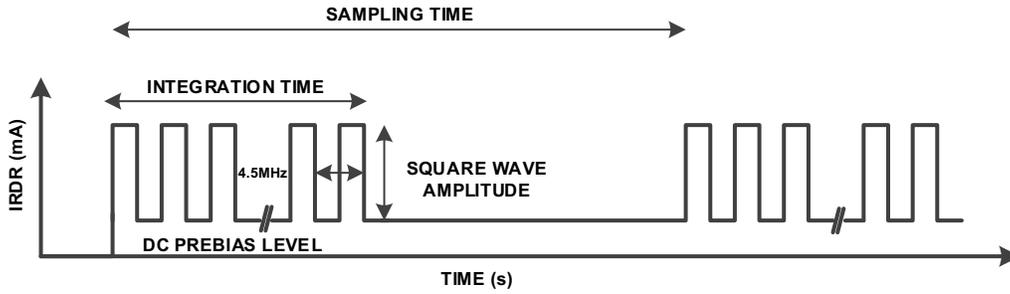
FIGURE 9. EMITTER DRIVER WAVE FORM
