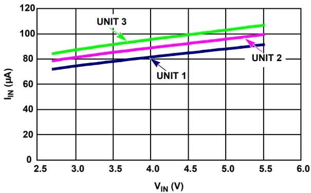
FIGURE 29. I<sub>IN</sub> vs V<sub>IN</sub> (3 UNITS)
