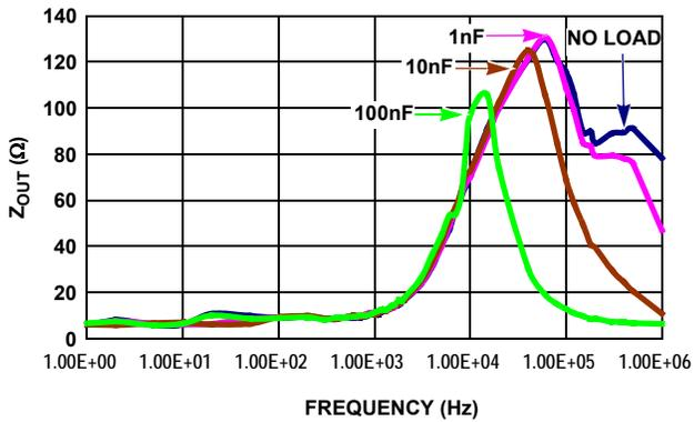
FIGURE 39. Z<sub>OUT</sub> vs FREQUENCY
