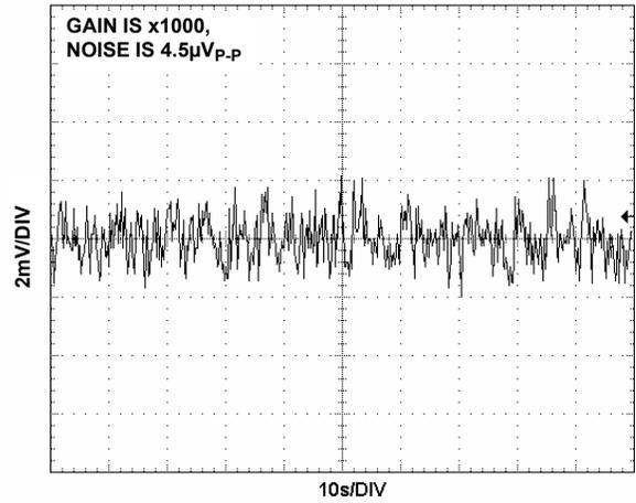
FIGURE 26. V<sub>OUT</sub> NOISE, 0.1Hz TO 10Hz
