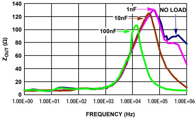
FIGURE 25. Z<sub>OUT</sub> VS FREQUENCY
