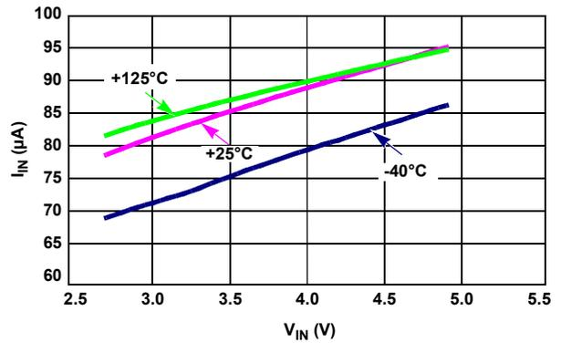
FIGURE 30. I<sub>IN</sub> vs V<sub>IN</sub> OVER TEMPERATURE
