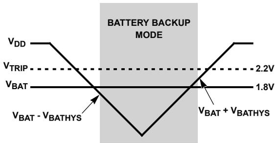
FIGURE 11. BATTERY SWITCHOVER WHEN  $V_{BAT} < V_{TRIP}$
