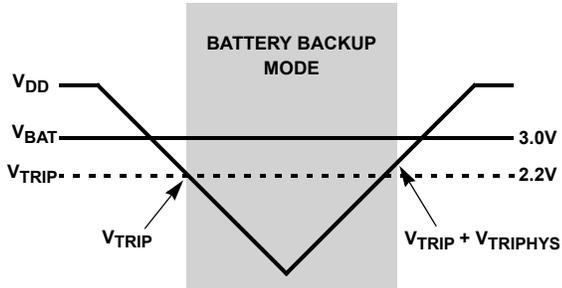
FIGURE 12. BATTERY SWITCHOVER WHEN  $V_{BAT} > V_{TRIP}$
