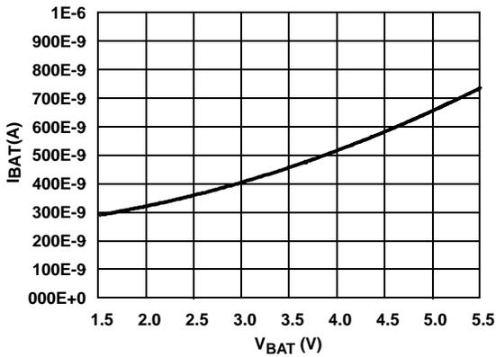
FIGURE 1. I<sub>BAT</sub> vs V<sub>BAT</sub>
